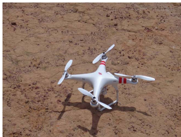
Figura 1-Modelo de VANT FC-40 utilizado na obtenção de imagens
