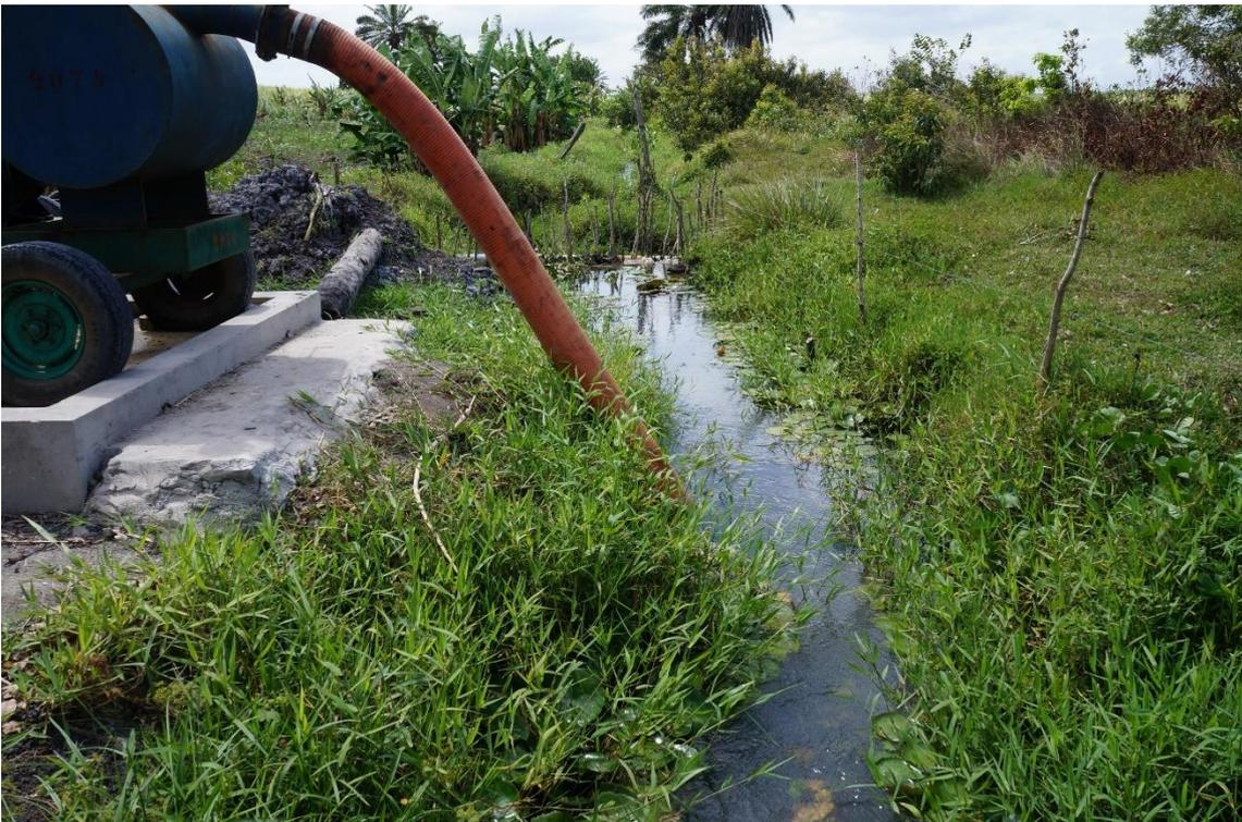
**Figura 27:** Bomba de captação de água no leito do riacho Cravaçu.
